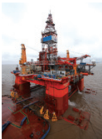
El “HYSY-981”, construido por la Corporación Nacional de Petróleo Submarino de China y la Corporación Nacional de Construcción Naval de China, constituye la sexta generación de la plataforma de aguas profundas de perforación semi-sumergible más avanzada del mundo.
