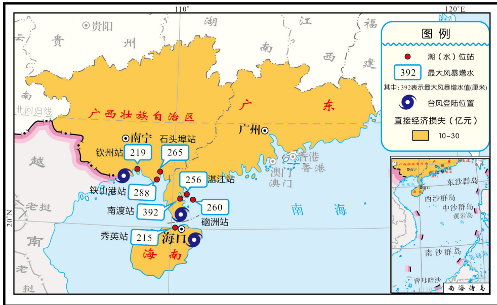
图3 “威马逊”台风风暴潮过程部分站位最大风暴增水
