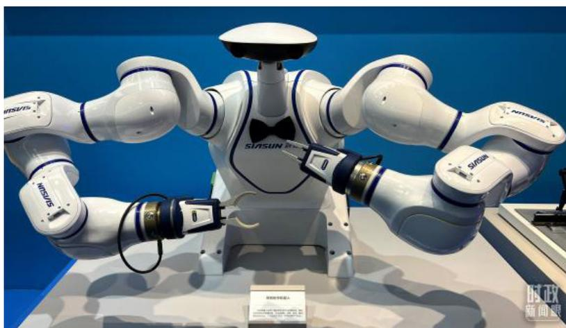
双臂协作机器人，可完成装配、涂胶、检测、搬运等自动化作业。
